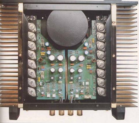
ome negli altri finali della casa di Vigevano quel che per primo attira l'attenzione è il dispiegamento di mosfet di uscita, che in questo caso sono quattro coppie per canale polarizzati per operare in classe A fino a (oltre) 5+5 watt su 8 ohm. Anche qui la struttura è bi-monofonica, con i due trasformatori toroidali affogati in resina all'interno di un cilindro metallico, e la componentistica attiva e passiva è attinta a piene mani dai migliori nomi dell'audio internazionale.
