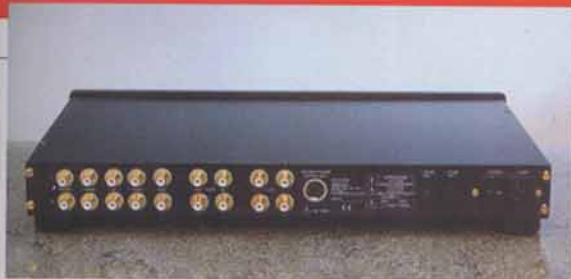
Il pannello posteriore del Pre 04 N è caratterizzato dalla presenza di connessioni di ottima fattura, e dalla presa per l'alimentazione di un preamplificatore phono.
