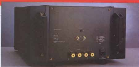
Il retro del finale comprende anche l'interruttore per il mantenimento della Classe A fino al 50% della potenza, riducendo l'energia assorbita ed il calore generato.
