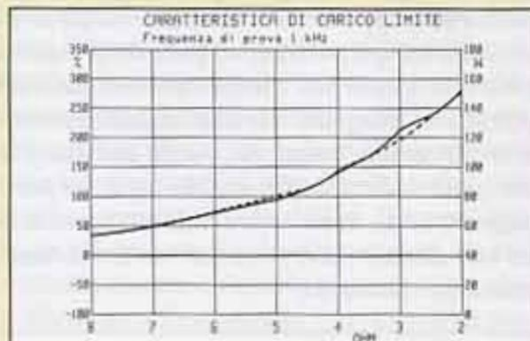
2b • Caratteristica di carico limite. Variazioni percentuali della potenza di uscita rispetto alla potenza nominale in funzione della resistenza di carico. Uno e due canali in funzione.
