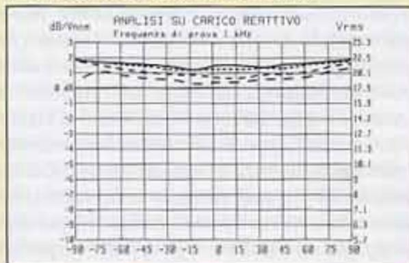
2a • Analisi su carico reattivo. Massima tensione in uscita in funzione del modulo e della fase del carico. Canale sinistro.
