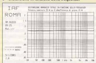
8a • Distorsione in funzione della frequenza a potenza fissa di 15 watt su 8 ohm.
