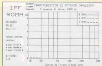
2c • Caratteristiche di potenza impulsiva. Incrementi della potenza di uscita in regime transiente rispetto a quella continua in funzione della durata del burst. Due canali contemporaneamente in funzione. Ciclo: 1S.
