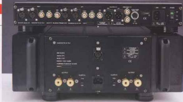
*La predisposizione per le connessioni bilanciate emerge chiaramente dalla vista dei pannelli posteriori. Da notare la presenza di due commutatori distinti (uno per lato) per la selezione della corrente di polarizzazione dei finali (50 e 100% del valore necessario ad ottenere la potenza nominale in classe A), che vanno ovviamente settati allo stesso modo.*
