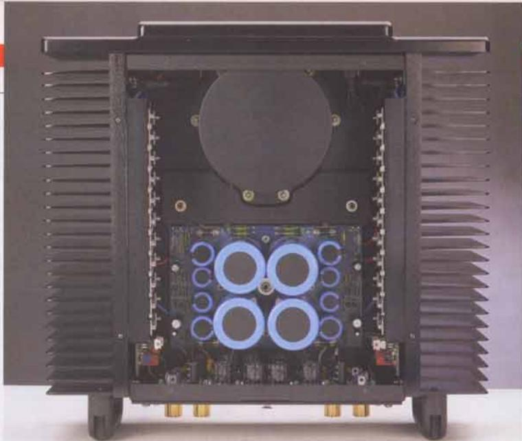
*L'interno del finale esprime molto bene il concetto di compattezza, perché in un volume contenuto contiene un numero davvero alto di dispositivi. Quelli che con più immediatezza colpiscono l'attenzione sono i finali (ben 44 mosfet selezionati) e gli elettrolitici di filtraggio, che totalizzano una capacità di poco inferiore a 0.4 farad.*
