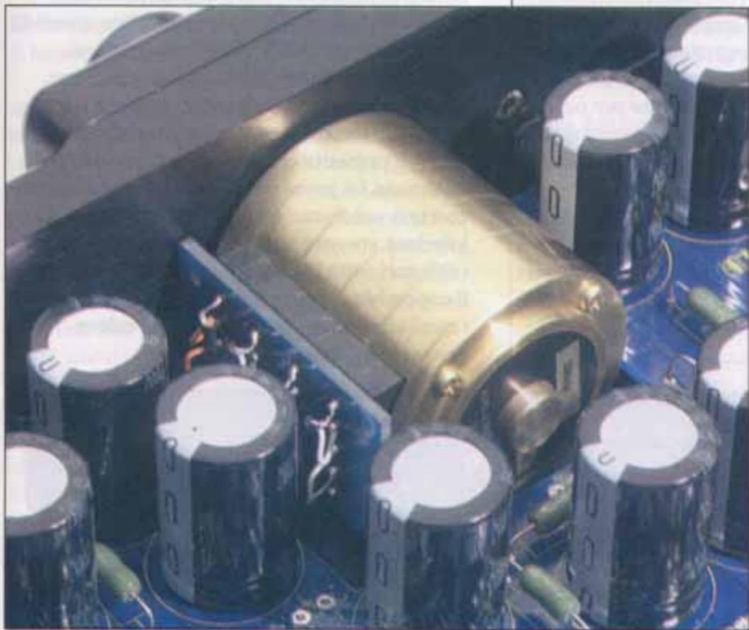
Un particolare del potenziometro ALPS a quattro strati contenuto in un involucro di metallo a fini protettivi dalle interferenze.
