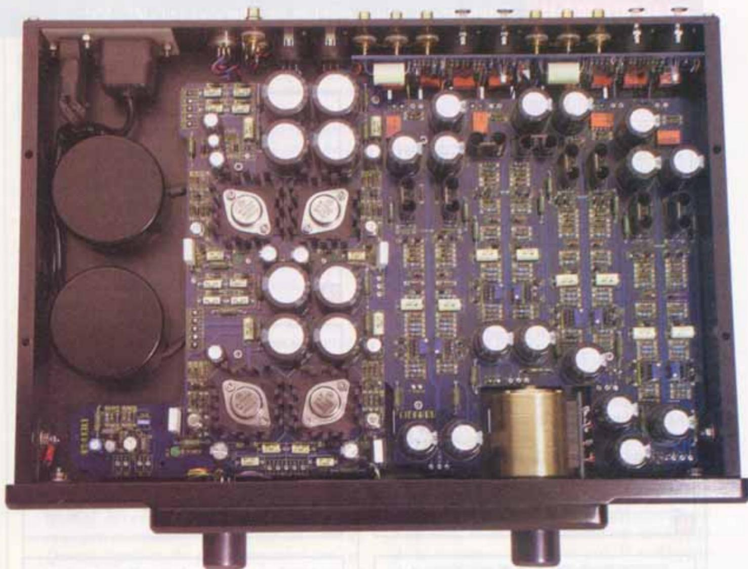
**Tutta la componentistica adoperata è di ottima qualità: sono utilizzate resistenze a strato metallico all'1%, condensatori in polipropilene e polistirene, trimmer in cermet, relé a contatti dorati, e componenti attivi selezionati. I circuiti stampati sono di vetronite spessa 2,4 millimetri, con doppia faccia e fori metallizzati, materiale che garantisce anche una notevole resistenza alle vibrazioni.**
