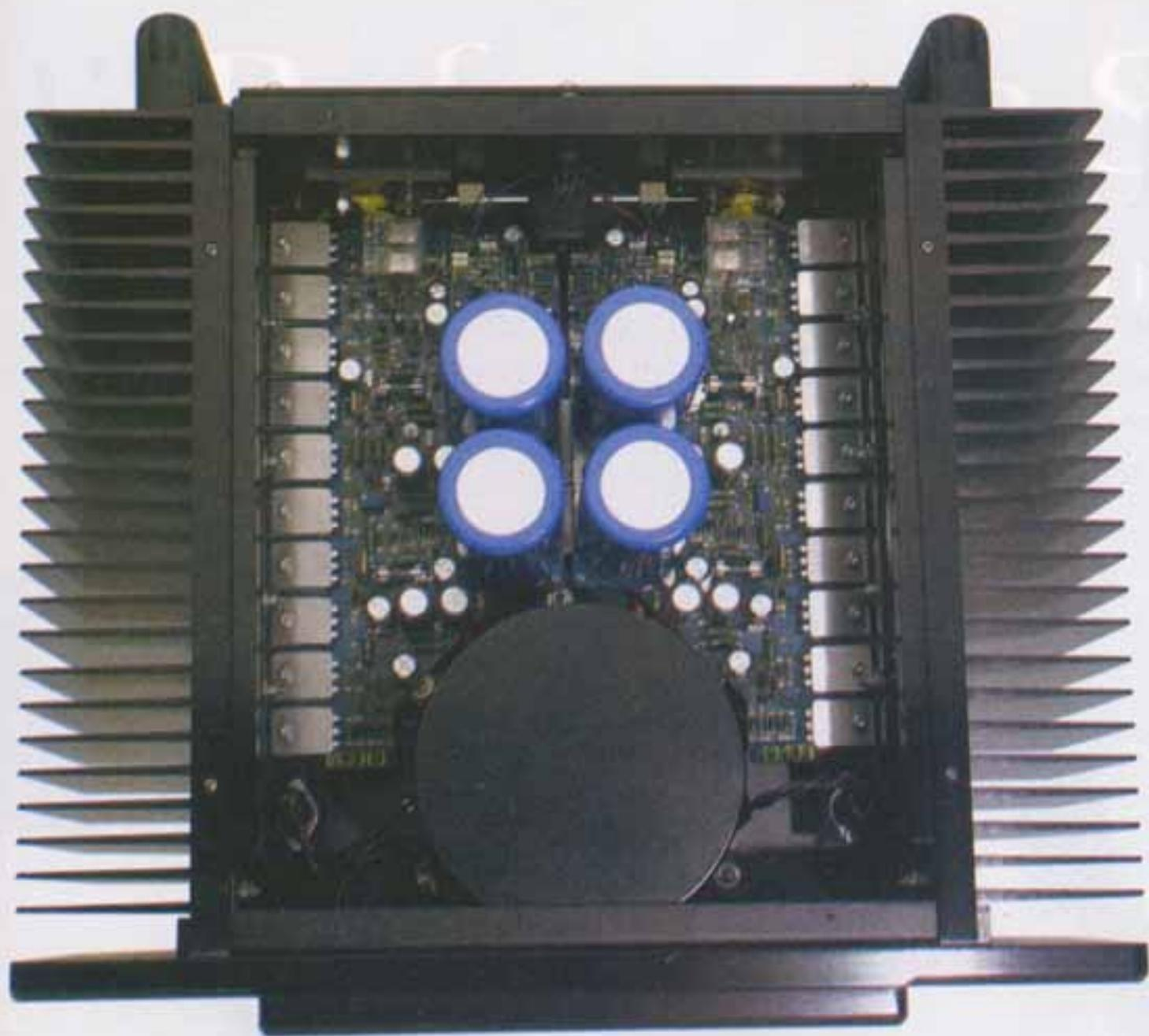
**Levando il coperchio superiore, si evidenzia un interno realizzato con molta cura: in particolare ci si sofferma immediatamente sul trasformatore toroidale, di generose dimensioni. Complessivamente una realizzazione molto robusta, la quale tiene conto di qualità, tranquillità e sicurezza di funzionamento.**
