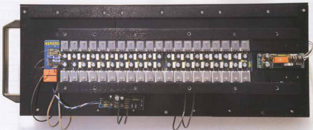
Una delle due banche che costituiscono gli stadi finali e contrapposti di un B-1000 Reference, con le relative 20 coppie di mosfet K1058/J162. Ogni dispositivo dispone di un doppio bypass locale di alimentazione, un elettrolitico da 47 \mu F ed un poliestere da 100 nF.
