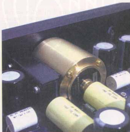
Particolare del notevole potenziometro a quattro sezioni RK-50, dell'Alps.
