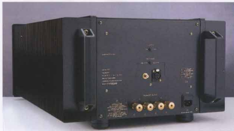
Il retro del finale, con i grandi e funzionalissimi morsetti serrafile, ben sfruttabili con cavi di notevoli dimensioni. Da notare anche il doppio ingresso bilanciato/sbilanciato ed il commutatore di modulazione, sempre presente nei classe A della Casa, per ridurre al 50% la potenza disponibile in classe A laddove (in pratica quasi sempre, nelle normali condizioni d'uso) non s'intenda sfruttare integralmente la dinamica dell'apparecchio.
