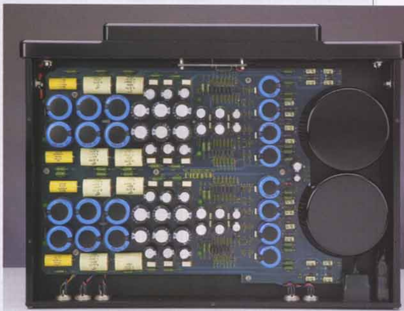
L'interno dell'unità di alimentazione del pre, che ha la particolarità più unica che rara di essere completamente passiva. La tensione pulsante proveniente dai rettificatori viene fortemente filtrata da più stadi in cascata e quindi consegnata agli stadi di amplificazione, a loro volta dotati di altre celle di filtraggio in serie.
