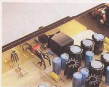
L'unico potenziometro presente nell'AM-1 (visto che per massimizzare la semplicità non è stato montato il bilanciamento) è un pregevole Noble blindato, connesso agli ingressi senza alcuna bufferizzazione.
