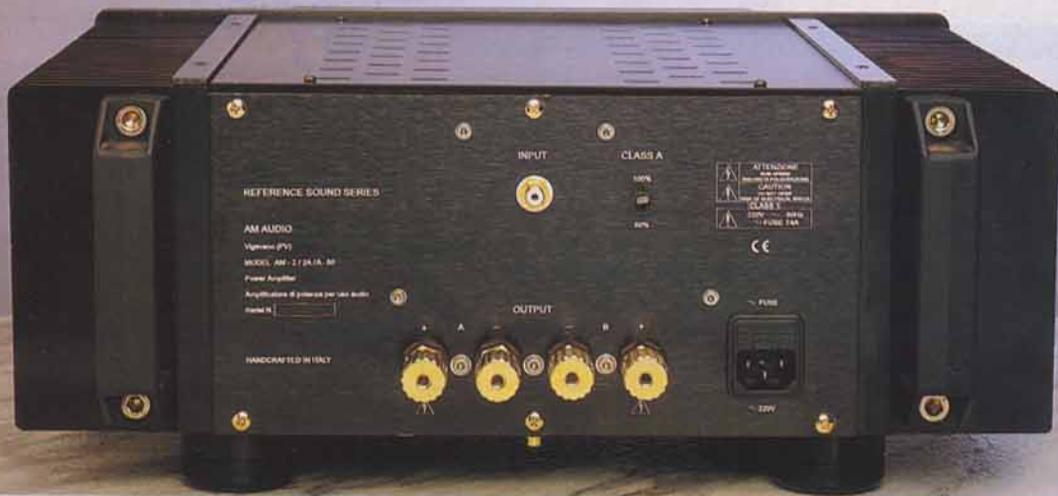
Sul pannello posteriore spiccano i bei morsetti in ottone dorato e l'interruttore che consente di diminuire la polarizzazione dei finali (e quindi la regione di funzionamento in classe A) per ridurre il riscaldamento ed il consumo di corrente.
