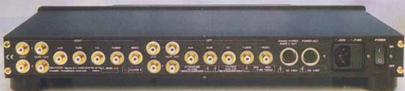
Il retro dell'A 5 presenta una disposizione inconsueta delle prese d'ingresso e uscite, conseguente all'impiego di due sezioni circuitali totalmente distinte.
