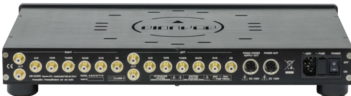
La dotazione input/output schiera sei coppie di ingressi e due di uscite, tutte sbilanciate.
