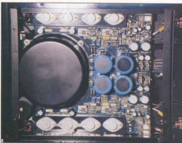
L'interno di un modello AM Audio è sempre una goduria visiva. L'enorme toroidale celato dal curato contenitore che è anche isolato elasticamente, enormi capacità di filtro e componentistica selezionata e di ottima qualità sono caratteristiche irrinunciabili per questa ditta.
