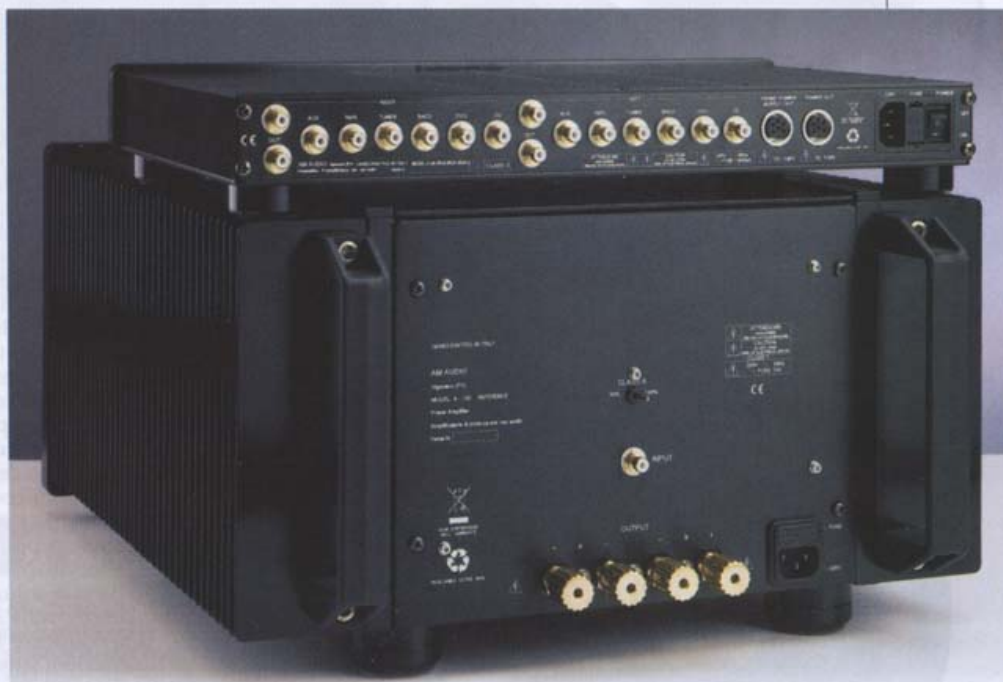
Il preamplificatore può servire sei differenti sorgenti e fornisce il segnale d'uscita a due possibili amplificatori di potenza: da notare le prese multipolari da utilizzare per alimentare eventuali apparecchi esterni, quali ad esempio un pre fono. Sul pannello posteriore del finale troviamo il commutatore per la modalità di funzionamento (50/100% classe A) ed i comodissimi morsetti per i diffusori.
