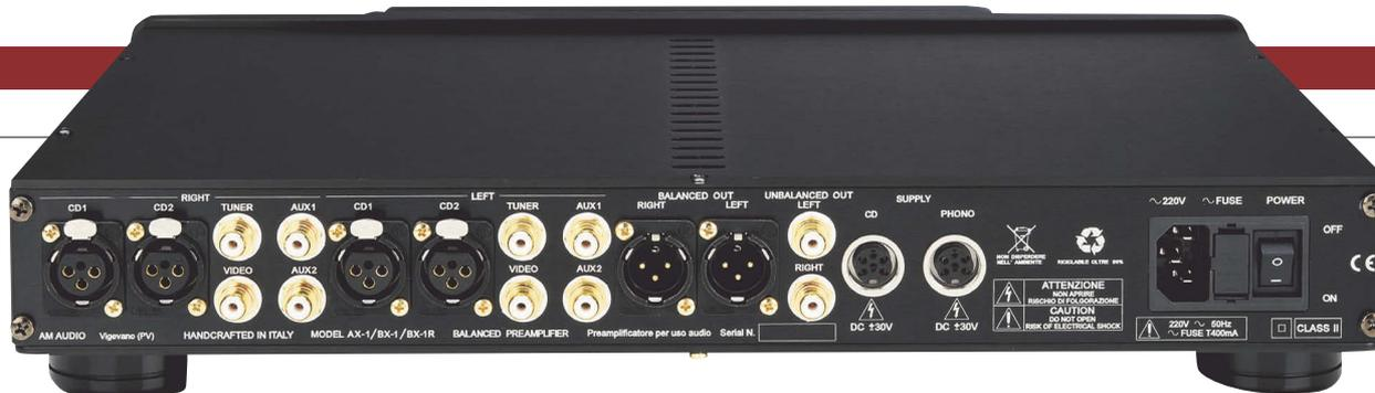
Come tutti i preamplificatori AM Audio, l'AMX accetta solo segnali a livello linea, pur essendo predisposto per fornire  $\pm 30$  volt a due unità esterne mediante connettori custom esapolari. Gli ingressi sono sei di cui due bilanciati, le uscite sono sia bilanciate che sbilanciate.
