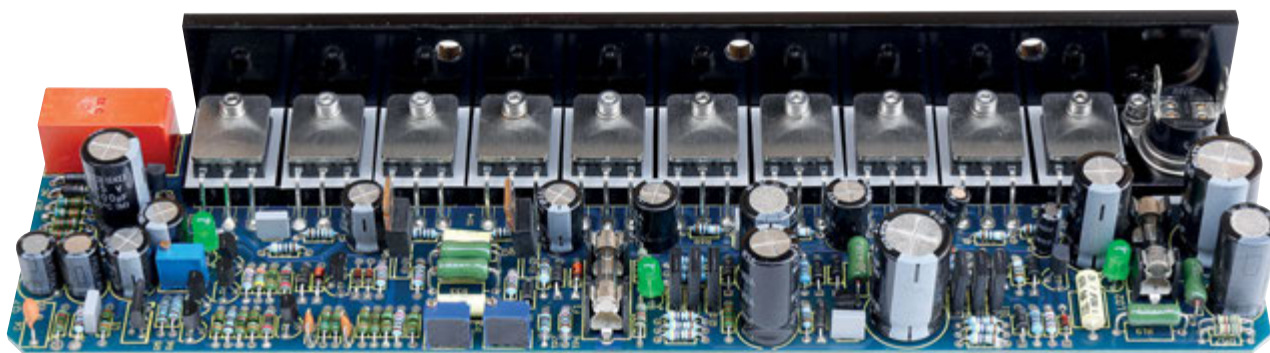
Una delle due bancate di amplificazione dell'integrato. La parte di potenza è affidata a 10 Mosfet.
