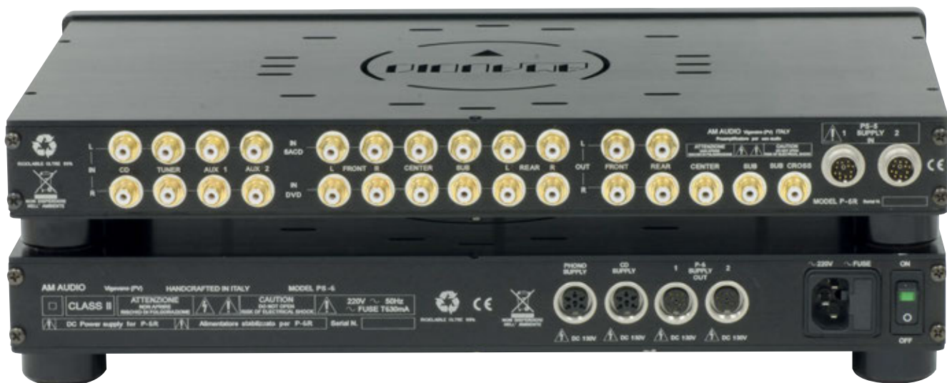
Confrontando il pannello posteriore del PX-6R con il precedente P-6R si nota la scomparsa dell'uscita tape, ormai effettivamente anacronistica. Gli ingressi a sei canali sono due, più altri quattro stereofonici.
