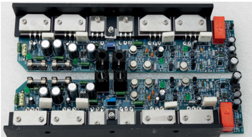
Le schede dei canali centrale/sub/posteriori, diverse da quelle dei frontali sinistro destro perché basate su tecnologia bipolare (i finali sono i ben noti Sanken in case MT-200 che abbiamo trovato in vari finali stereo hi-end), anche se lo stadio d'ingresso è comunque ad effetto di campo.
