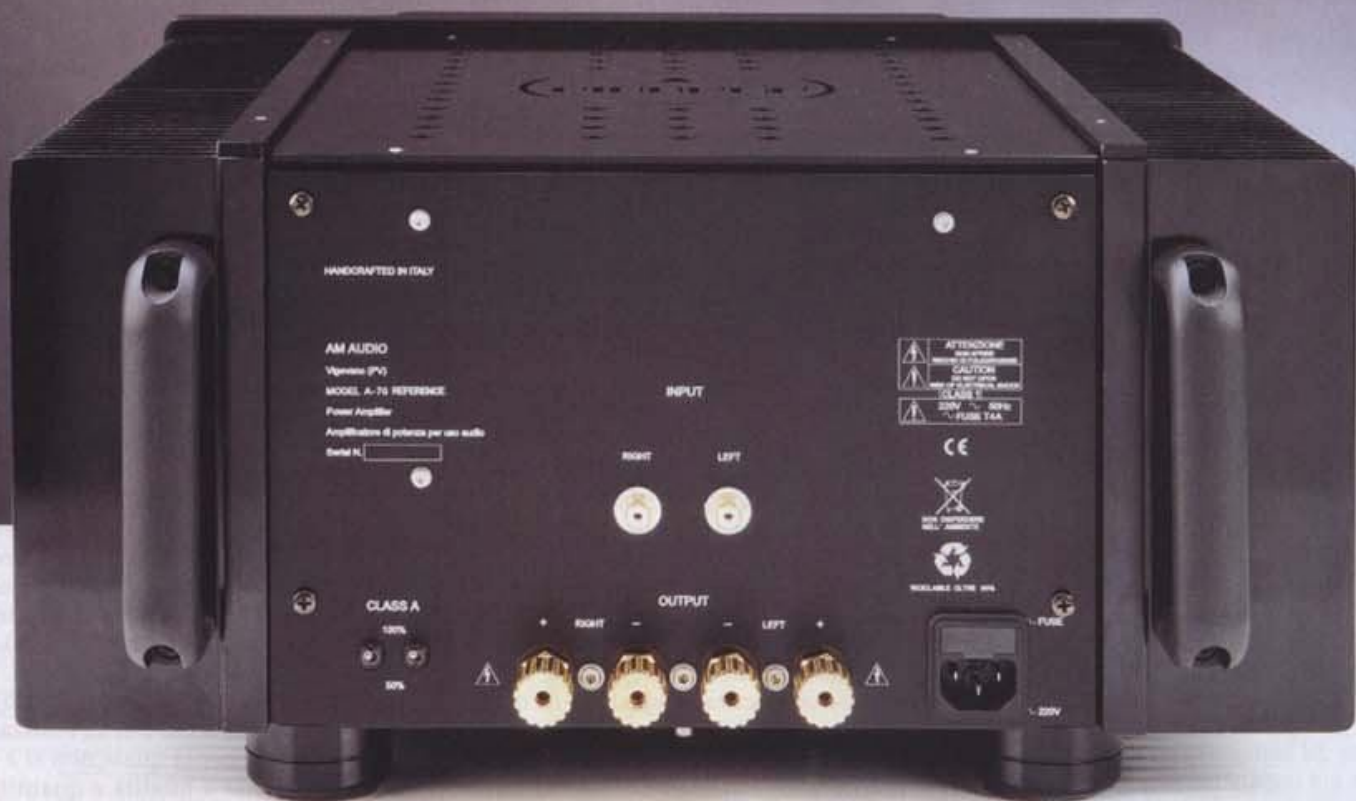
Sul pannello posteriore è presente solo l'ingresso di tipo sbilanciato, sebbene la circuitazione consenta anche di aggiungerne uno bilanciato. Nella parte bassa troviamo i pregevoli morsetti per i diffusori e, sulla sinistra, i due interruttori che consentono di ridurre la corrente di polarizzazione dei finali.
