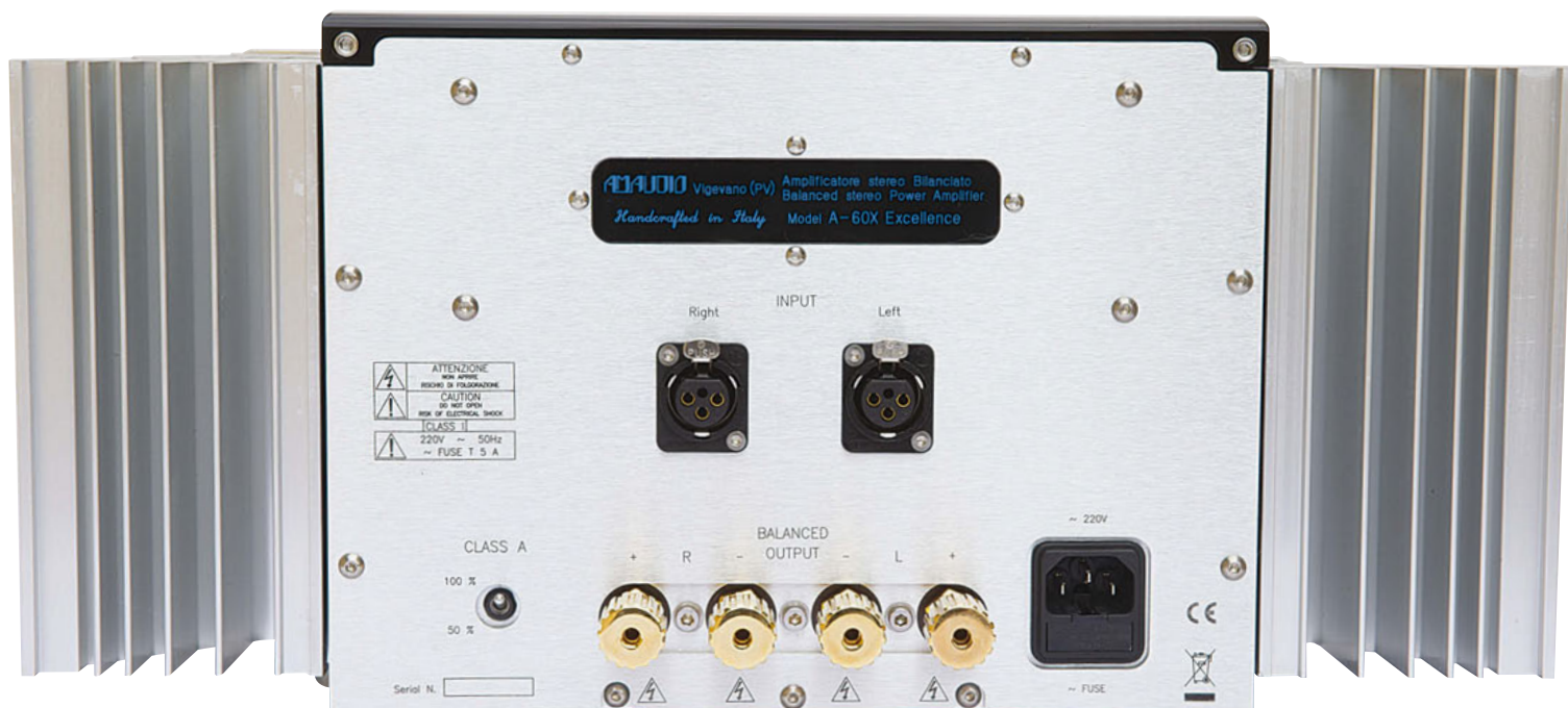
Il pannello posteriore, in tutta la sua sfavillante imponenza. Non esistono connessioni sbilanciate, sono vietate dal codice AM Audio serie X!
