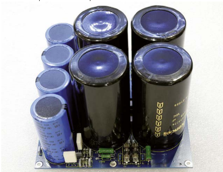
Un gruppo di filtraggio dell'alimentazione, assemblato e collaudato.
