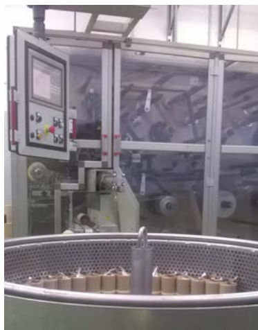
Figura 1. Macchina d'avvolgimento dei condensatori di ultima generazione.
