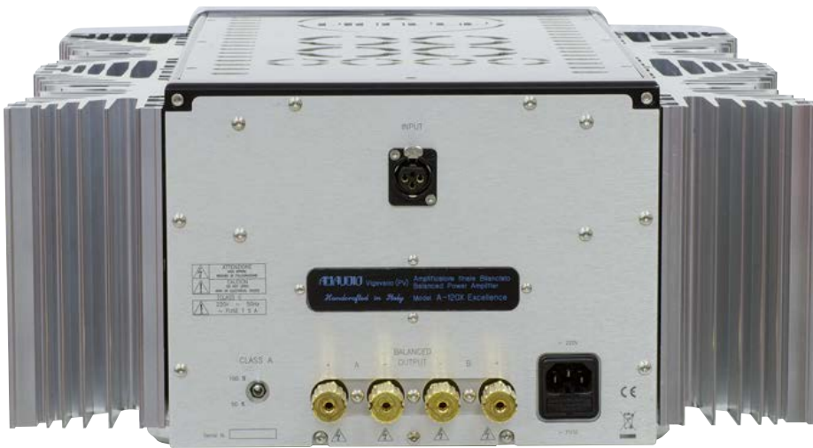
Al centro del pannello posteriore l'ingresso che accetta solo segnali bilanciati mentre le bocche per i cavi dei diffusori consentono il bi-wiring. In basso a sinistra si trova l'interruttore per la selezione della percentuale di funzionamento in classe A.
