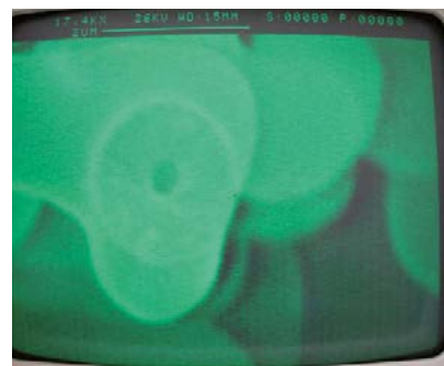
Figura 5. Un tubo di ossido nel foglio anodico, scala da 2 micron.
