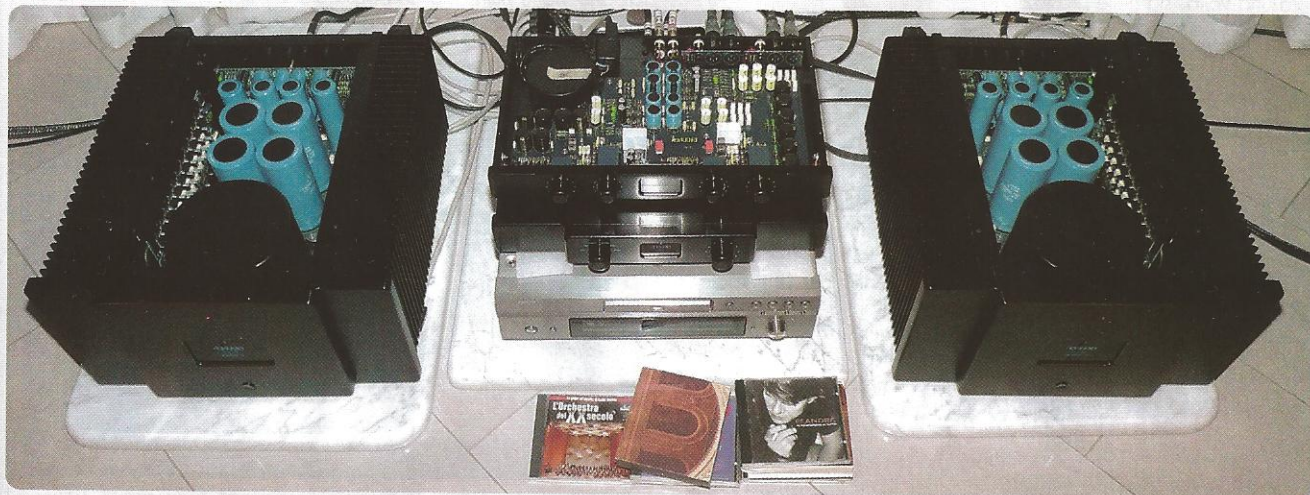
Preamplicatore AM Audio AMX Reference, crossover elettronico AS-3 e finali monofonici B-130 Reference. La sorgente è il Denon 3930 multistandard modificato dalla stessa AM Audio. Non sono visibili nella foto i finali A-80 che pilotavano le due unità subwoofer.
