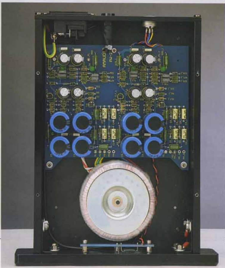
Vista interna dell'unità di alimentazione PW-2. Notare il trasformatore toroidale da 50VA.
