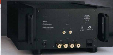
Sul pannello posteriore del finale compaiono soltanto i jack RCA per l'ingresso e i massicci e comodi morsetti per i diffusori; in basso a sinistra i due deviatori a levetta per la scelta della modalità di funzionamento.
