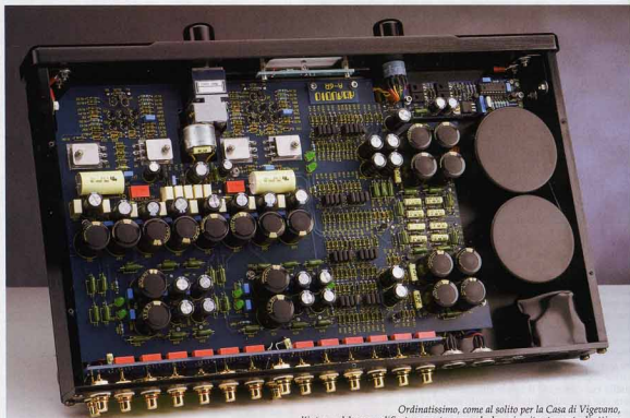
Ordinatissimo, come al solito per la Casa di Vegetano, l'interno del preamplificatore mostra una scheda a circuito stampato di ottima fattura, sulla quale trovano posto tutti i componenti; si noti la realizzazione completamente dual-mono visibile nella completa simmetria della realizzazione.
