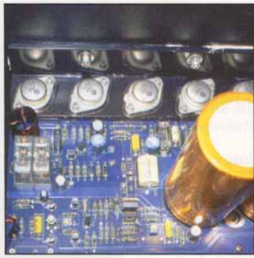
Parte dei MosFet di un canale, e di uno dei due stampati di nuova fattura.
