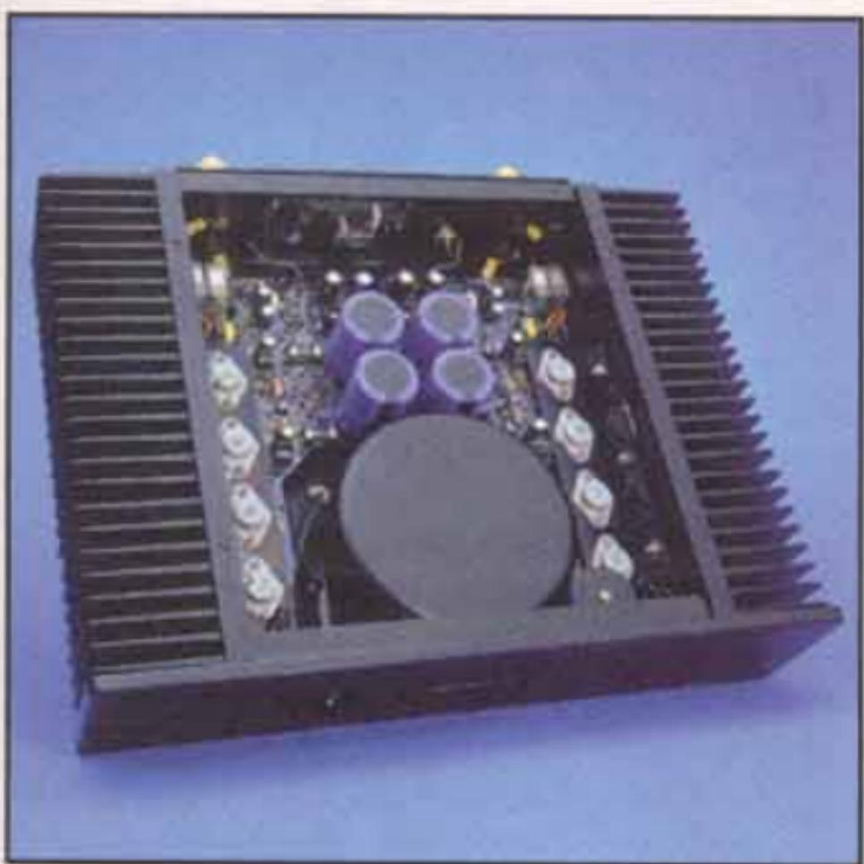
**L'interno dell'M-120 si presenta con la solita, rassicurante cura costruttiva AM Audio. In primo piano il poderoso toroidale, affogato nella resina e inserito in contenitore metallico.**
