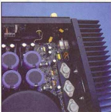
**Un dettaglio di una delle due schede che ospitano la circuitazione di ciascun canale. Si notano alcuni dei MosFet, su un ripiegato metallico a ridosso degli efficaci dissipatori di calore.**
