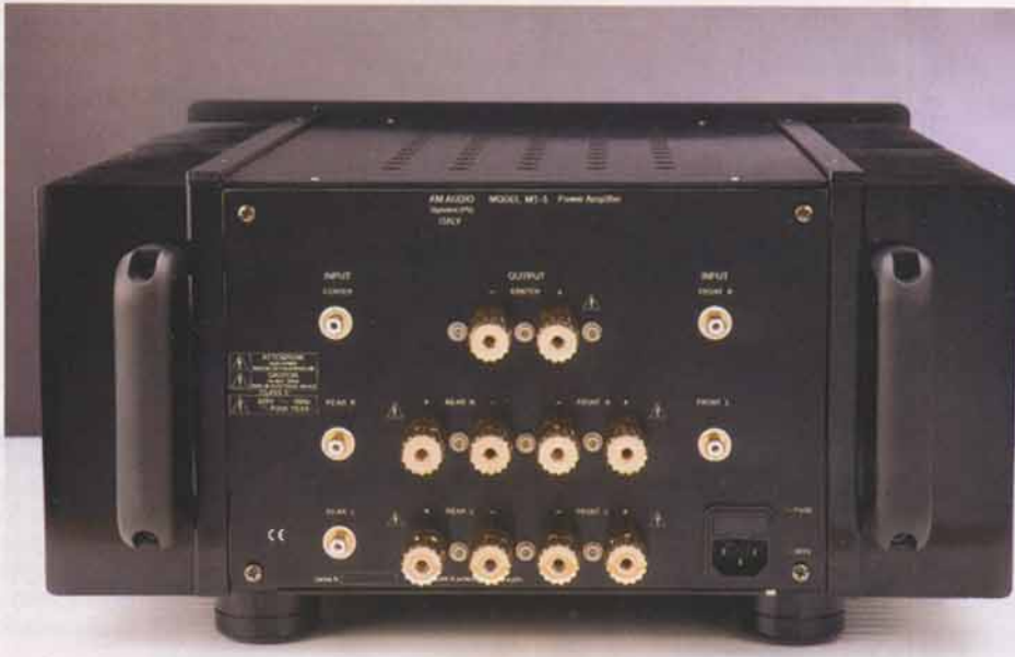
La prima cosa che balza agli occhi sono le dimensioni dei morsetti di uscita: comodi da usare, grandi a sufficienza per consentire il serraggio di qualsiasi cavo e dorati. Raramente ho trovato morsetti così soddisfacenti.
