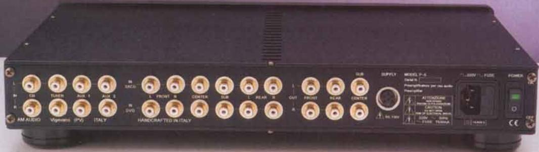
Sul pannello posteriore sono ospitati quattro ingressi a due canali, due ingressi a sei canali e sei uscite.
