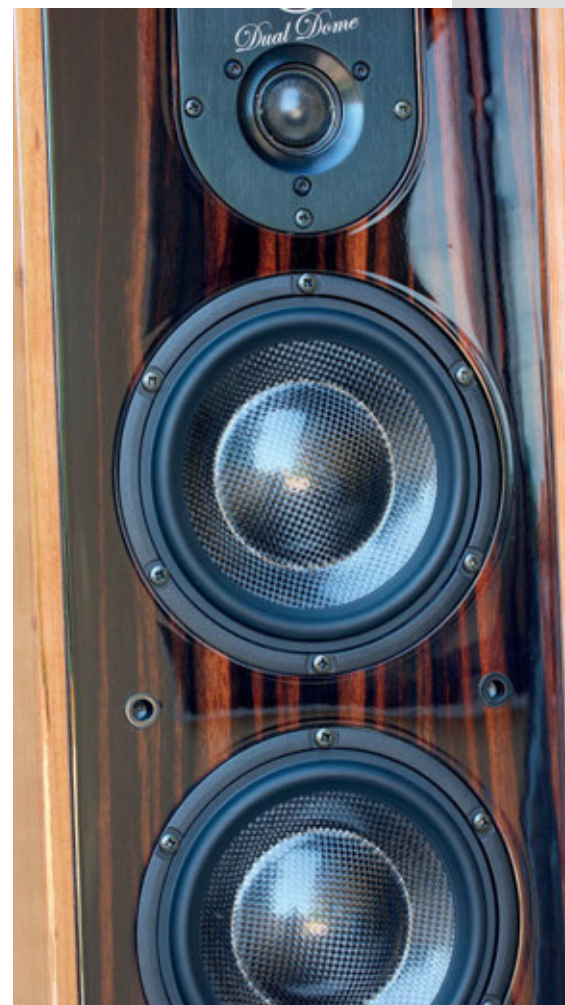
I coni degli altoparlanti da 16 cm sono in fibra di carbonio.
