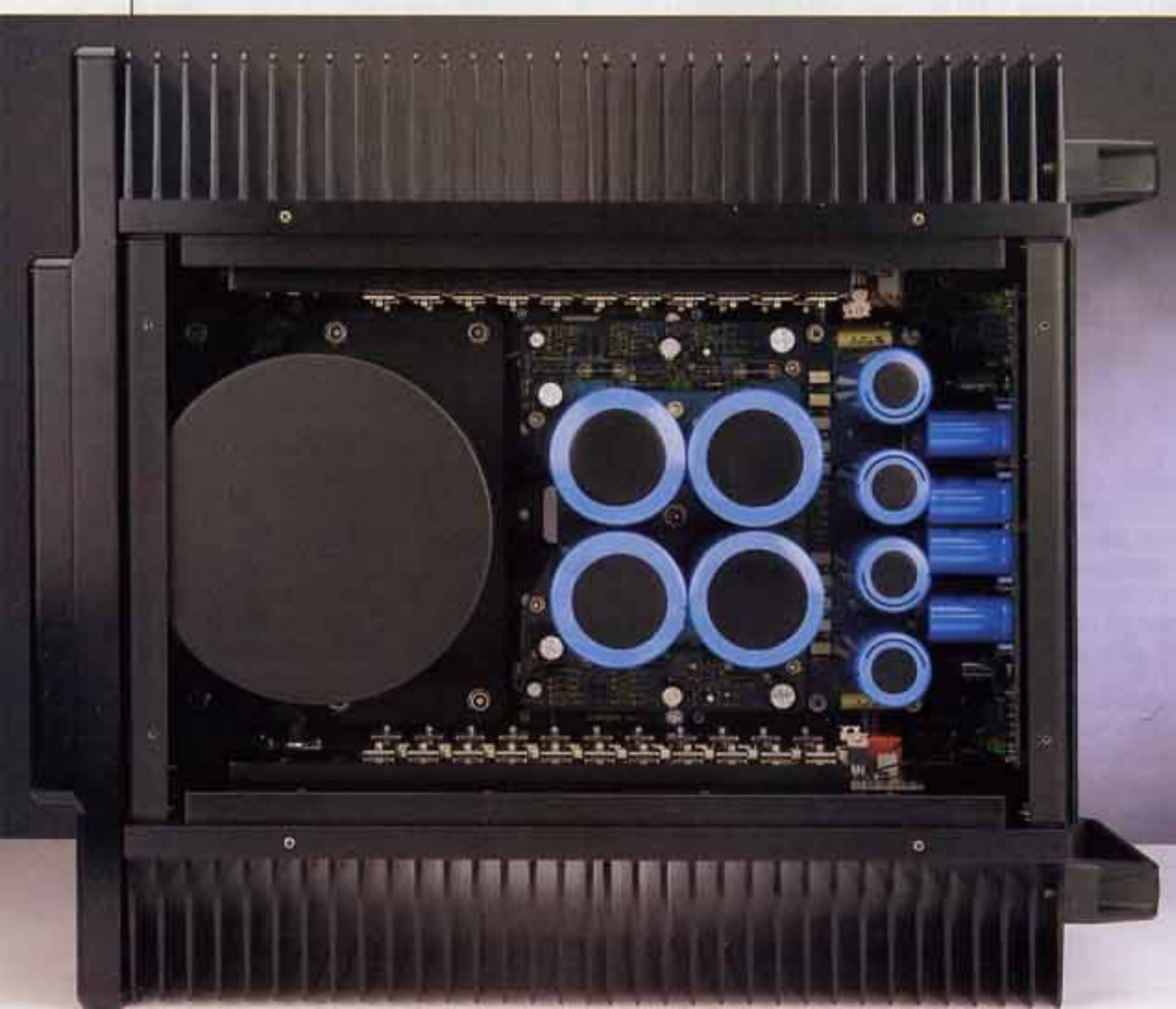
Figura 3. Uno dei due lati speculari dello stadio di ingresso del finale B-130 Reference. Come già ad esempio nel B-80R (AR 242) la struttura generale del finale è quella intrinsecamente bilanciata costituita da due unità a ponte, con rete di reazione comune e floating rispetto a massa, che in Italia vedemmo per la prima volta (se la memoria non m'inganna) nel finale Sumo Andromeda alla fine degli anni '70 e che anche chi scrive adottò per la versione bilanciata del kit The Smart Audio Driver. La topologia richiama da vicino quanto implementato nel preamplificatore, sia per l'alimentatore stabilizzato che per l'amplificatore. Il primo presenta ancora varie resistenze in serie (ben 4) e ricorre anche qui agli ottimi BD137/138, il secondo è quasi uguale al pre, con guadagni ovviamente adattati al diverso scopo, ed anche in questo caso l'anello di reazione si chiude sull'uscita dell'amplificatore di tensione, per un fattore di reazione intermedio calcolabile in circa 35 dB. In ingresso è presente un filtro passa-basso, ma con frequenza di taglio talmente alta (600 kHz) da non avere effetto osservabile nell'uso pratico.
