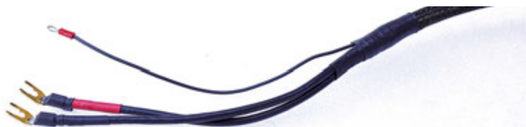
I 1.200 conduttori tutti isolati vengono terminati a crogiolo e saldati a mano sui robusti connettori. In alto l'occhiello che ancorato al telaio dell'ampli permette di attuare la schermatura del cavo.
