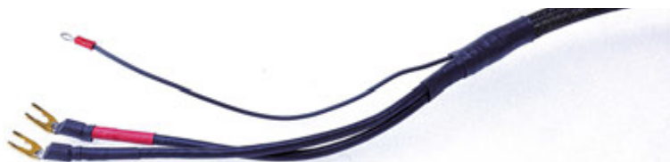
I 1.200 conduttori tutti isolati vengono terminati a crogiolo e saldati a mano sui robusti connettori. In alto l'occhietto che ancorato al telaio dell'ampli permette di attuare la schermatura del cavo.
